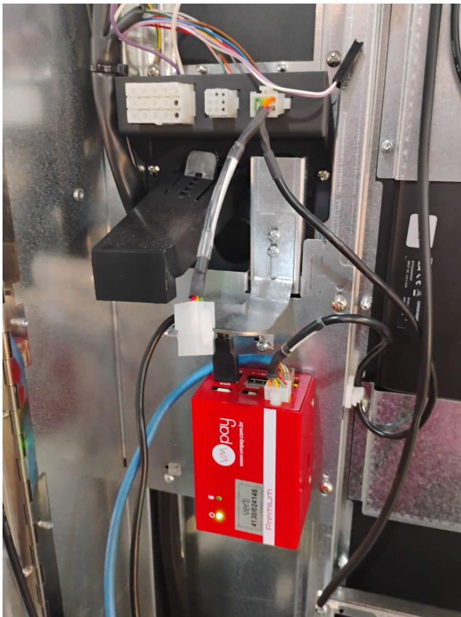
Figura 07 – Chicote onde foi conectado o cabo MDB
