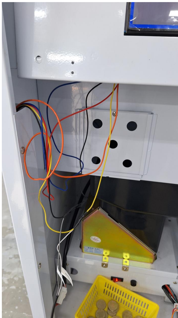
Figura 23 – Fios de pulso do Hopper
